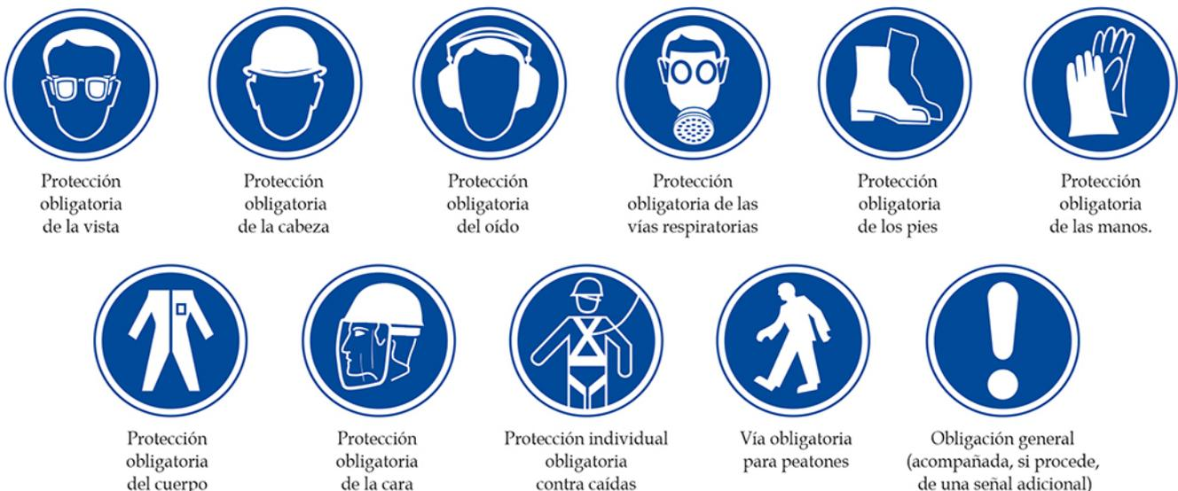
Figura 5. Ejemplos de señalización de EPI.
